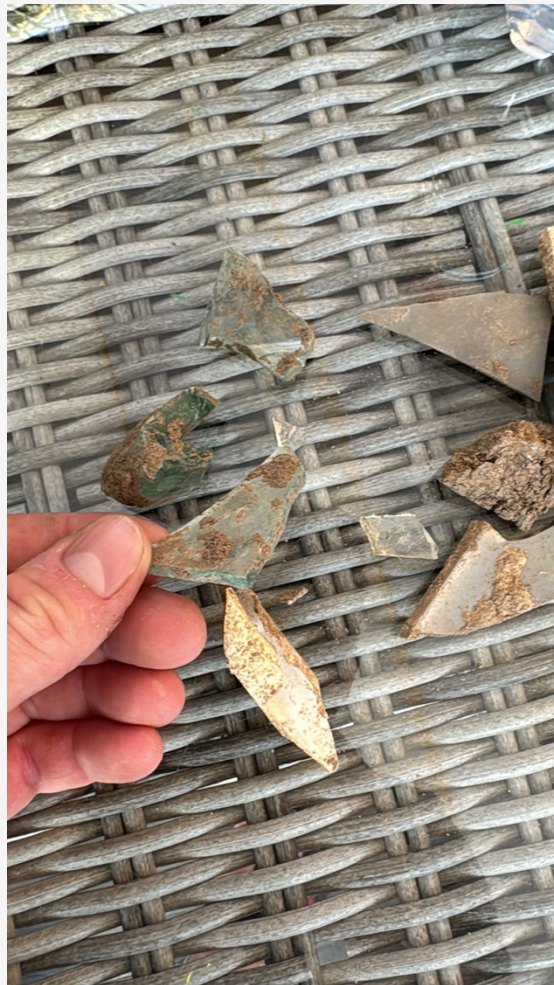
Foto 2. In het aangebrachte zand aangetroffen glasscherven (groen en helder glas), met zichtbare aanslag/verwering.
