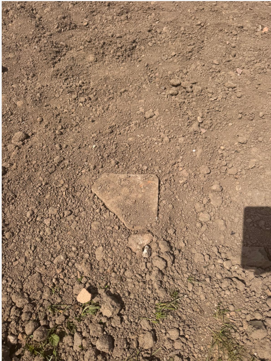
Foto 5. Hard fragment (steen-/tegel-/puinmateriaal) in het aangebrachte zand.
