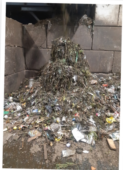
Foto 4: Vervuiling die tijdens verwerking uit GFT wordt gehaald (zeeftrammel: fijne stoorstoffen worden uit het GFT verwijderd).
